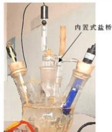
图4. 电解池与电极的连接图
