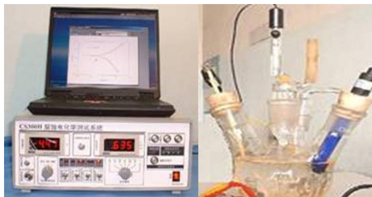
图1 CS300电化学测试系统和专用电解池
