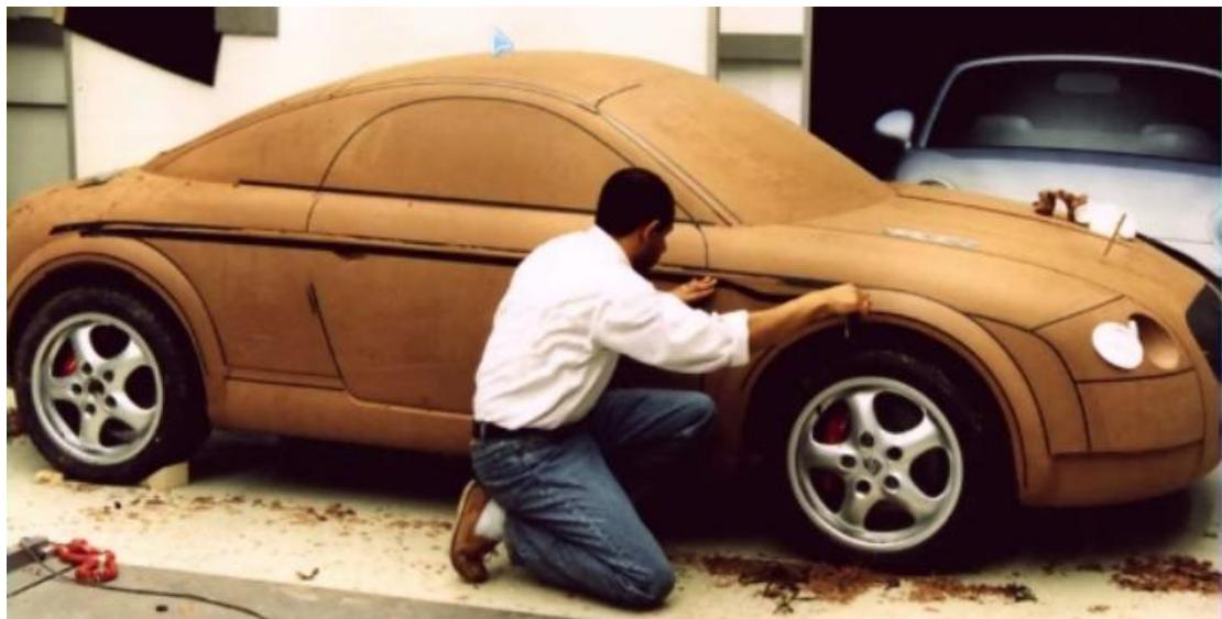
图 4 小车油泥模型
