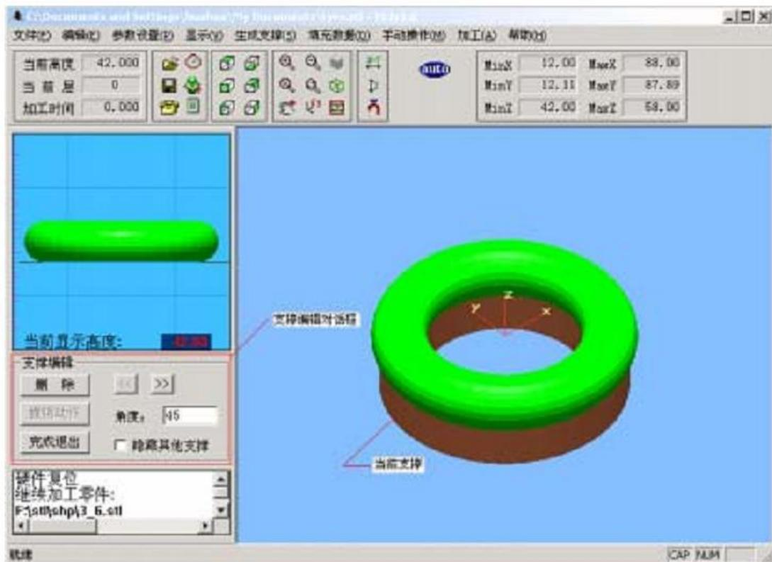
图 5.23 支撑编辑对话框
