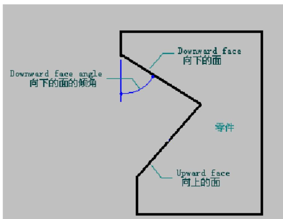
图 5.22 生成支撑 对话框角度参数的几何意义
