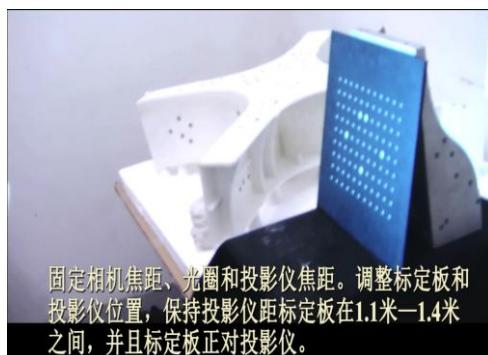
固定相机焦距、光圈和投影仪焦距。调整标定板和投影仪位置，保持投影仪距标定板在1.1米—1.4米之间，并且标定板正对投影仪。
