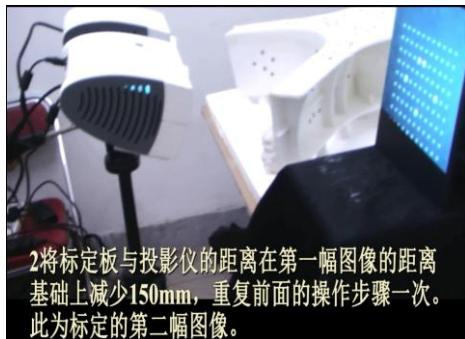
2 将标定板与投影仪的距离在第一幅图像的距离基础上减少150mm，重复前面的操作步骤一次。此为标定的第二幅图像。
