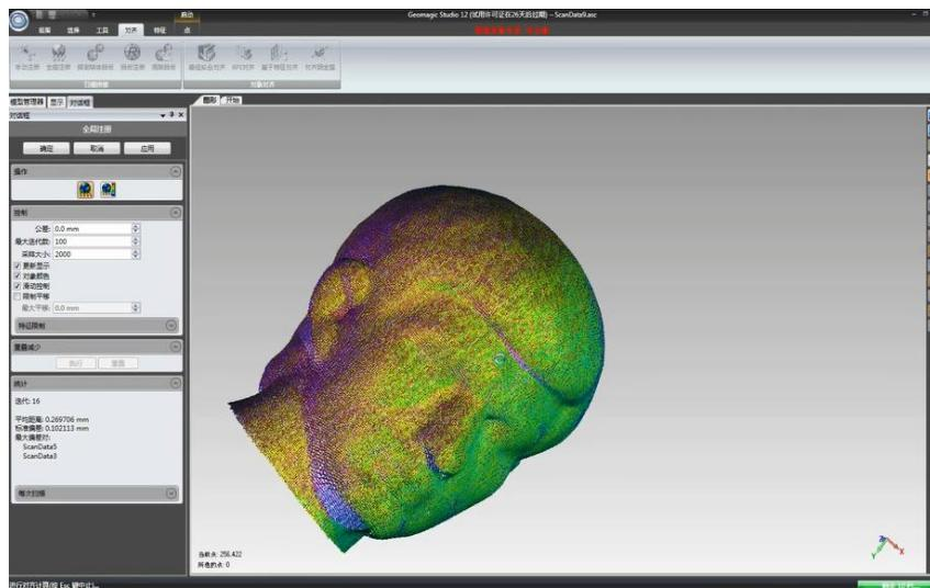
(6) 点击“点”菜单下的“合并”按钮，用三角形面片将点云合并成面片模型。进入面片处理界面，通过“填充”、“删除丁状物”“砂纸打磨”等按钮将面片模型表面进行优化，得到完整且美观的模型。
