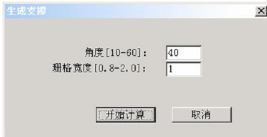
图 5.21 生成支撑对话框
