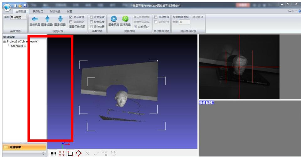
7. 沿着固定方向（顺时针或逆时针）将零件旋转一个角度（一般是 45 度），重复以上步骤，直到旋转到与第一次被测物体的位置重合，测量得到零件完整的三维点云数据。
