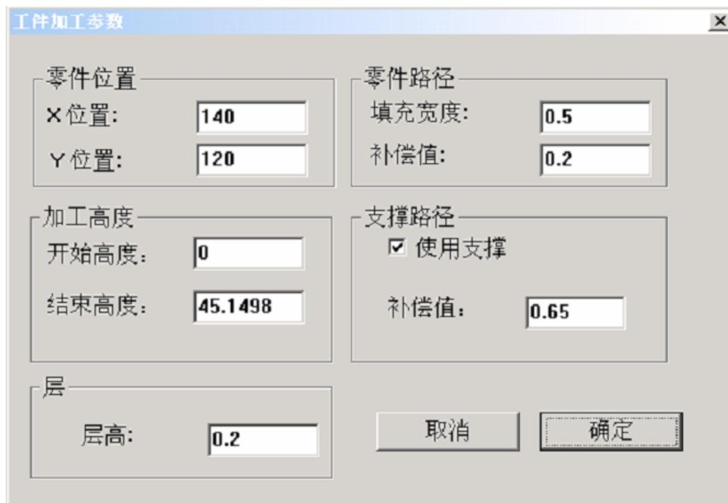
图 5.14 工件参数对话框的参数设定
