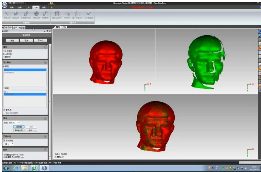
(5) 点击“确定”按钮，回到“对齐”界面，点击“全局注册”按钮，软件自动通过曲线曲面的识别技术，优化对齐，光顺曲面。
