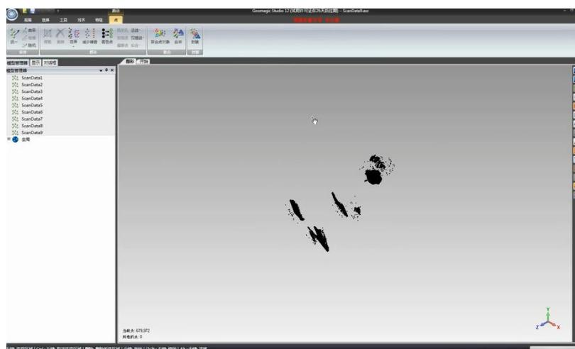
(2) 对点云数据进行预先处理，通过“着色”按钮将所有点着色，通过“选择”按钮选中体外孤点与非连接点，将误差较大的点删除。
