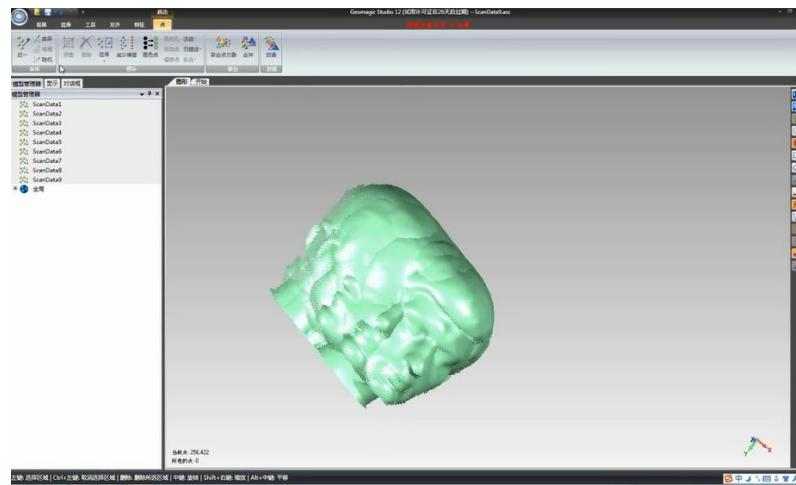
(3) 点击“对齐”菜单下的“手动注册”按钮，进入手动拼合按钮界面，选定特征点，软件通过将两幅图中同一特征点重合的方式将其拼合。
