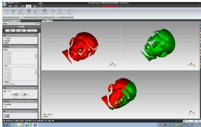
(4) 重复上述操作，将九幅图依次拼合，形成一个完整的点云数据模型。
