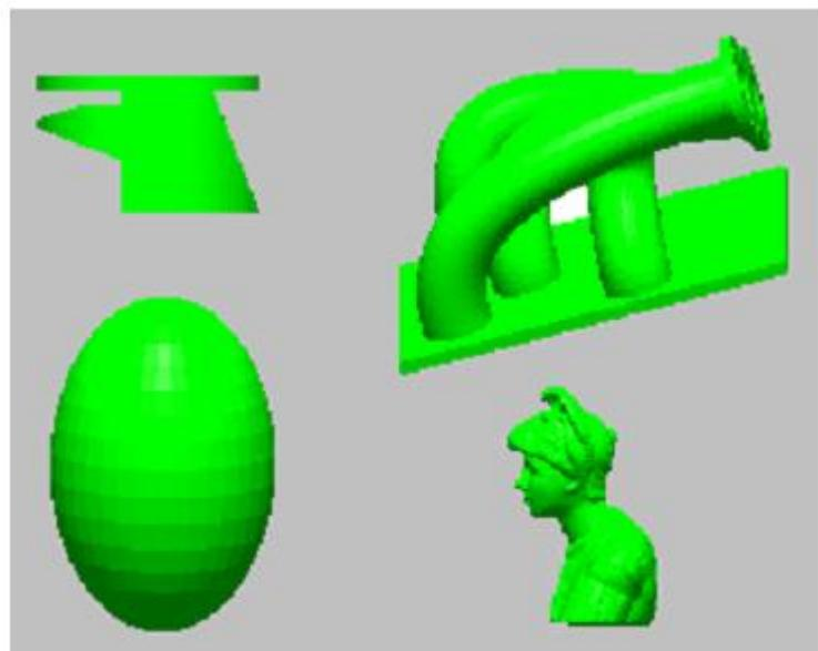
图 5.18 具有悬臂结构的零件
