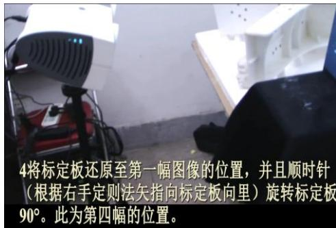
4 将标定板还原至第一幅图像的位置，并且顺时针（根据右手定则法矢指向标定板向里）旋转标定板90°。此为第四幅的位置。
