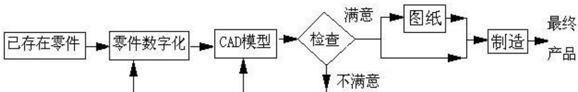
图 2 反求工程
