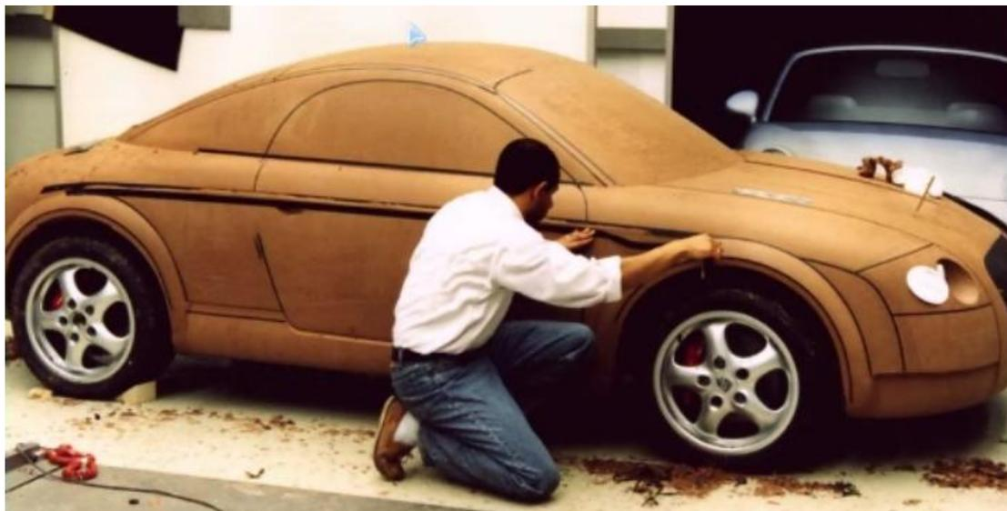
图 4 小车油泥模型
