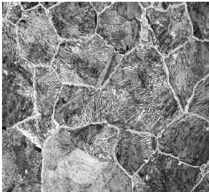
图 2-8 过共析钢体显微组织 500×,浸蚀剂: 4%硝酸酒精溶液
