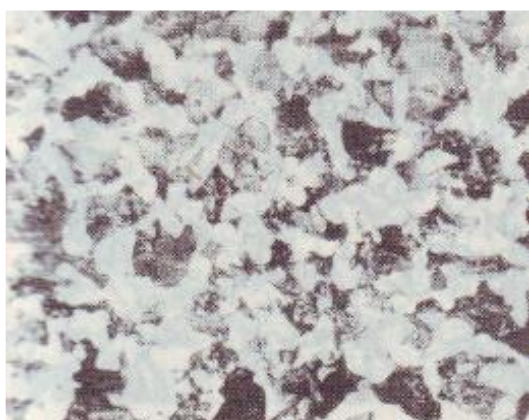
图 6-6 45 钢正火组织珠光体及铁素体
