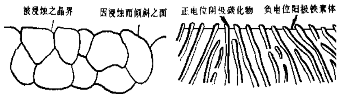
图 5-1 浸蚀作用原理图
