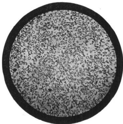
图 6-8 铁素体和粒状渗碳体 (球化处理, 400×)
