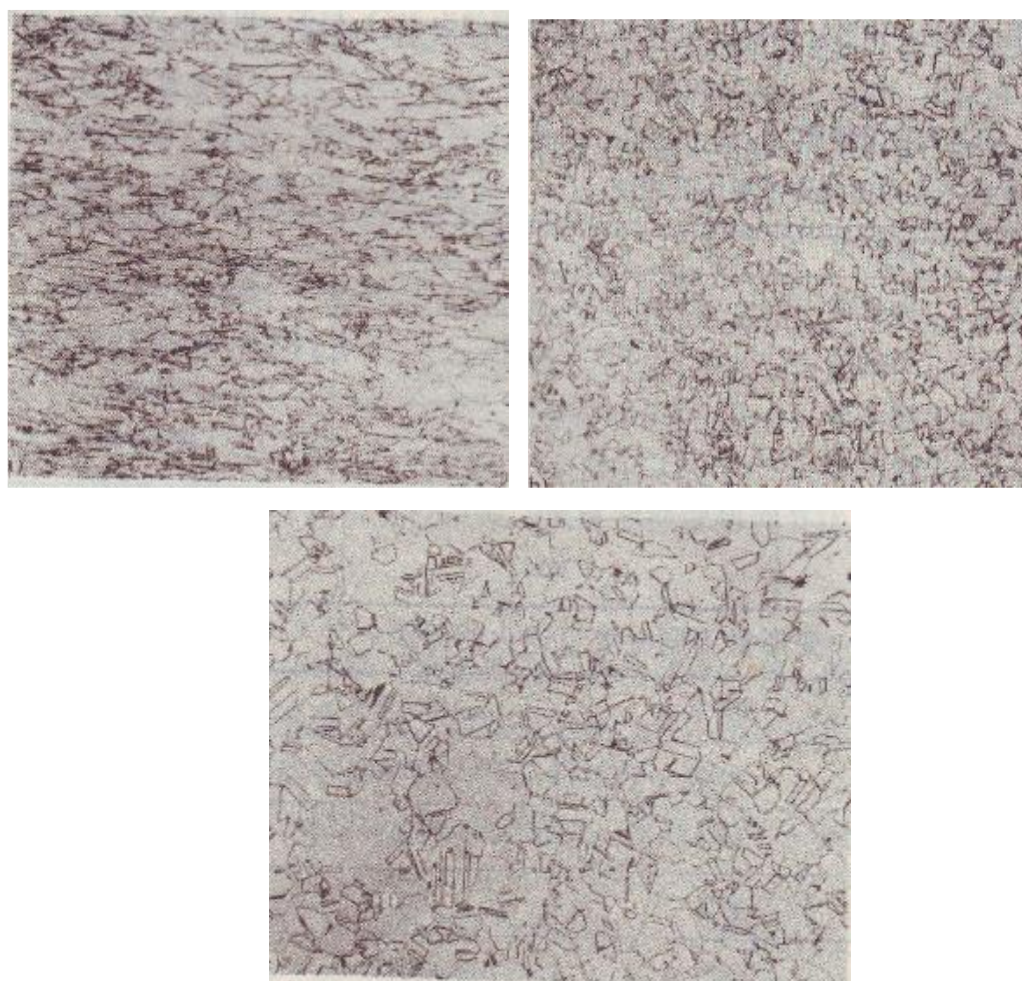
图 4-7 变形量 50% 的纯铜在不同温度下加热时显微组织的变化 100× a 300°C b 500°C c 600 °C 加热时间 30min
