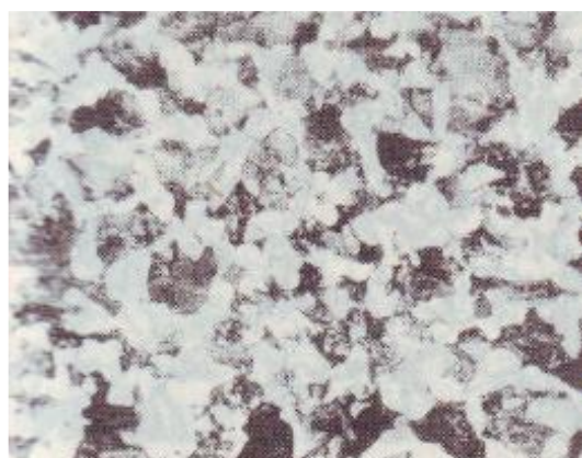
图 4—8 45 钢正火组织珠光体及铁素体
