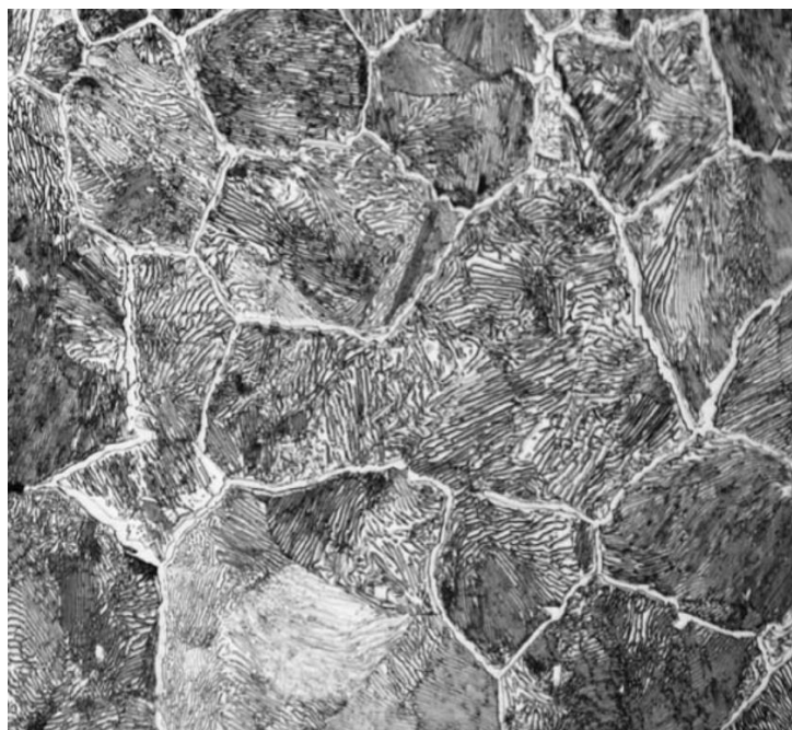
图 2-8 过共析钢体显微组织 500 \times ,浸蚀剂: 4%硝酸酒精溶液
