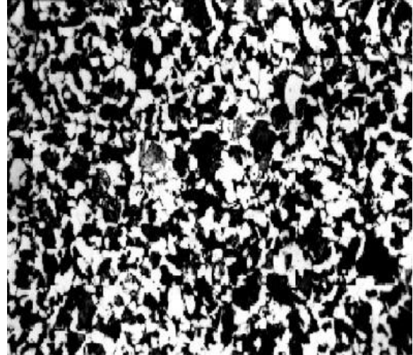
图 2-5a 亚共析钢显微组织 500×, 浸蚀剂:4%硝酸酒精溶液 图 2-5b 40 钢显微组织 400×,浸蚀剂:4%硝酸酒精溶液
