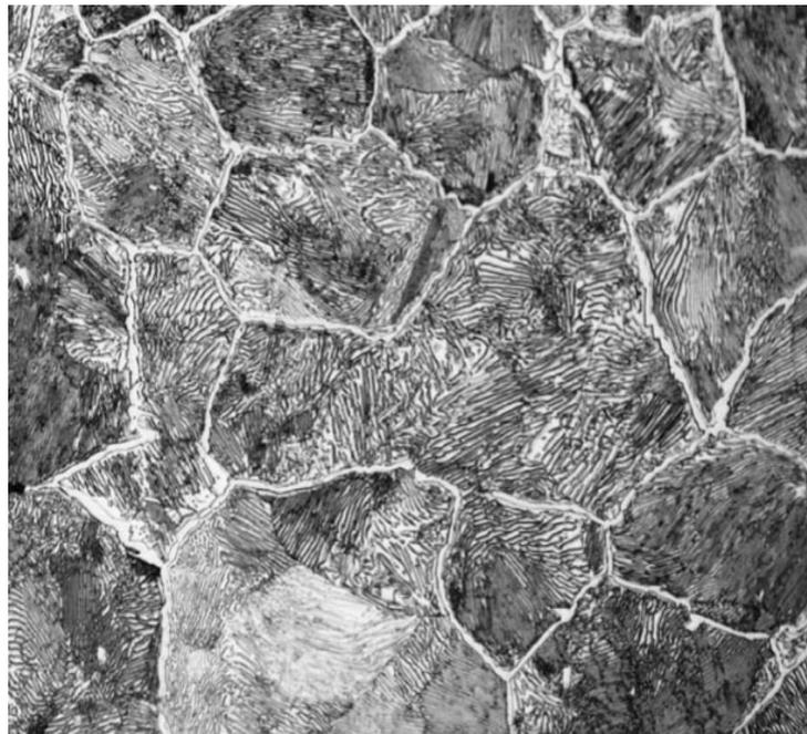
图 6-8 过共析钢体显微组织 500×,浸蚀剂: 4%硝酸酒精溶液
