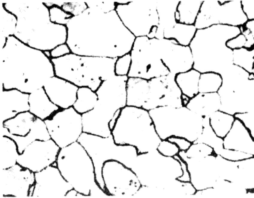
图 6-2 工业纯铁的显微组织 (300×) 浸蚀剂: 4% 硝酸酒精溶液
