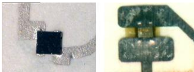
图2 RFID中导电胶互连
