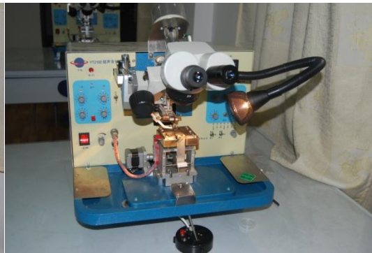
图 5 YT2102 型金丝球焊机
