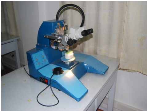
图 4 YT129 铝丝焊线机
