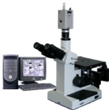
图 1-8 4XCE 金相显微镜
