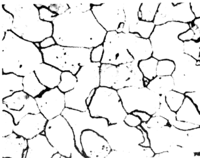
图 4-2 工业纯铁的显微组织 (300×) 浸蚀剂: 4% 硝酸酒精溶液
