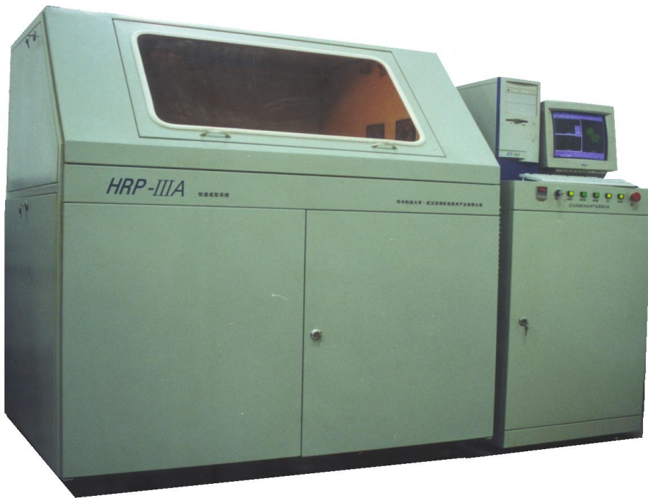
华中科技大学研制的 HRP-III A 型 LOM 装备
