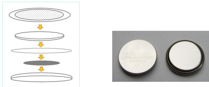
图 5 扣式电池结构示意图
